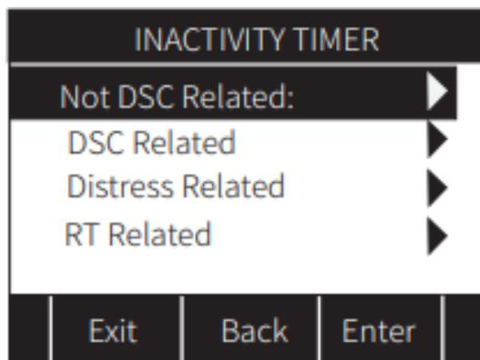
Станция позволяет настроить автоматический выход на главный экран из следующих режимов:
